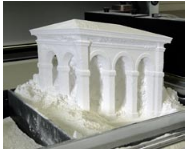
Abb. 16: Bergen der »Bogenhalle« aus dem 3D-Drucker der Modelle schichtweise aus 3D-Datensätzen aufbauen kann. Damit existieren in Dresden die Voraussetzungen, die Modelle Burmesters für die Sammlung auf zeitgemäße Weise – mit den Mitteln des Rapid Prototyping – zu rekonstruieren: Burmesters Objekte und Kleinarchitekturen werden unverzerrt in einer 3D-Modeling-Software (Cinema4D) konstruiert, anschließend mit einem speziell hierfür entwickelten Algorithmus reliefperspektivisch verzerrt und zuletzt als Reliefmodelle »ausgedruckt«. Abbildung 16 zeigt die Bergung des Modells »Bogenhalle« aus dem Bauraum des 3D-Druckers, Abbildung 17 die »Typischen Grundkörper« als fertiges Modell im Guckkasten.
